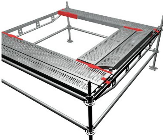
**Schritt 4:** Wechselbeläge in die BABT einschieben
